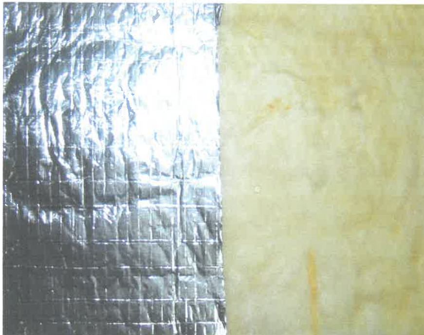
Рисунок 1 – Зовнішній вигляд зразка теплоізоляційного матеріалу на основі скляного штапельного волокна, марки ISOTEC MAT AL виробництва ООО «Сен-Гобен Строительная Продукция Рус», який було надано для випробувань».
