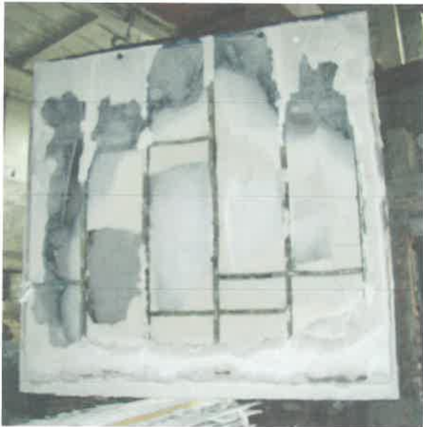
Вигляд зразка №2 після випробувань зі сторони вогневого впливу
