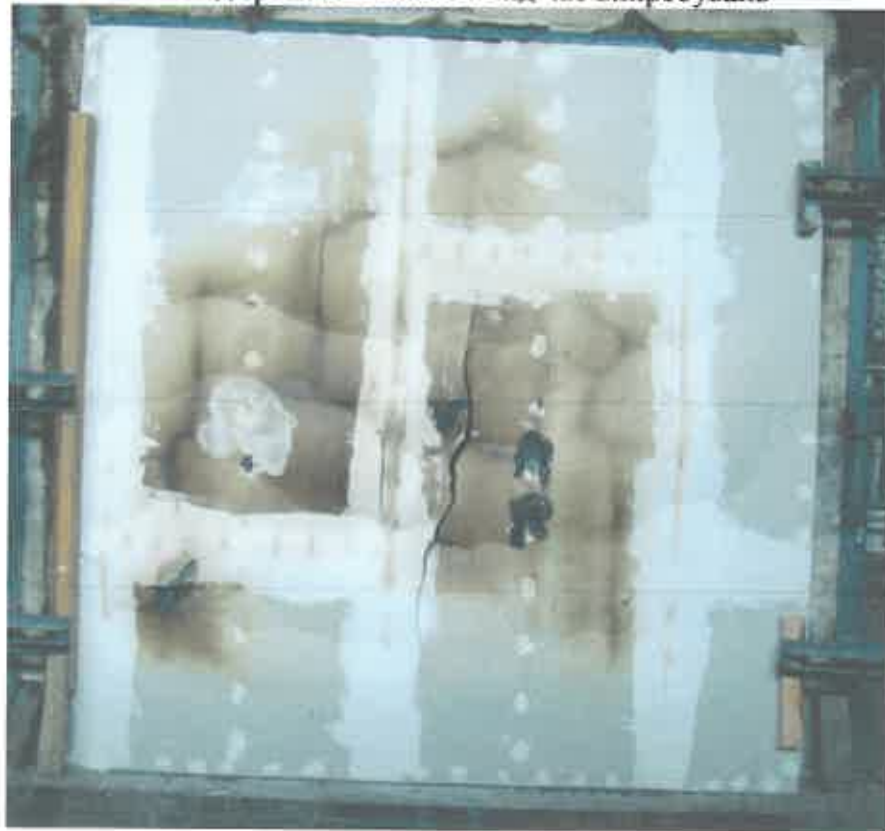
Вигляд зразка №1 на печі під час випробувань
